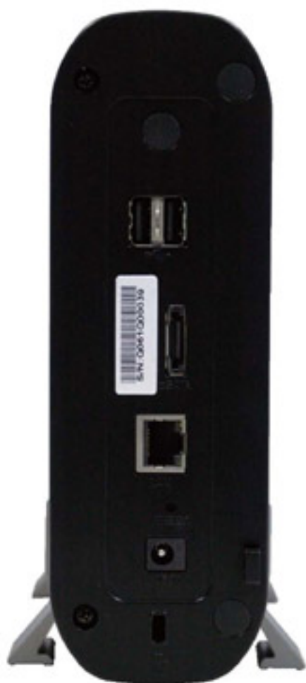
▲TS-101 Turbo Station機背所具備的各連接埠，最下方還有一個安全鎖裝置。
